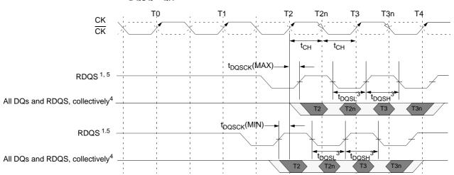
Note : 1.  $t_{\mbox{\scriptsize DQSQ}}$  represents the skew between the 8 DQ lines and the respective RDQS pin.
