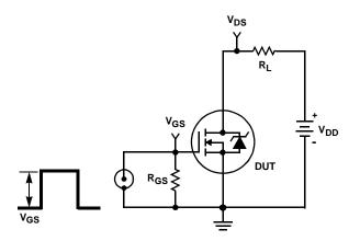
FIGURE 18. SWITCHING TIME TEST CIRCUIT
