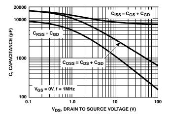
FIGURE 12. CAPACITANCE vs DRAIN TO SOURCE VOLTAGE
