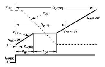
FIGURE 17. GATE CHARGE WAVEFORMS
