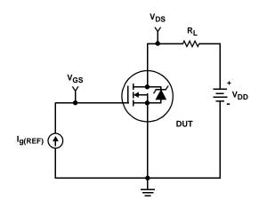
FIGURE 16. GATE CHARGE TEST CIRCUIT
