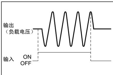
具有零交叉功能的SSR在交流负载电压为零或接近零时动作。
