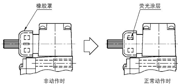
把带细缝的黑色橡胶罩套入旋转轴的根部, 然后将连杆扳至适当O.T.(动作后位移)后, 即可从细缝处看到荧光着色部分。经过这样的改进后, 可从较远处进行确认, 初始设定更加便利。
