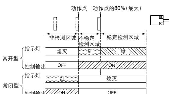
注:若检测体材质为铝、铜、不锈钢等与标准检测体(铁)不同时, 指示灯颜色变
