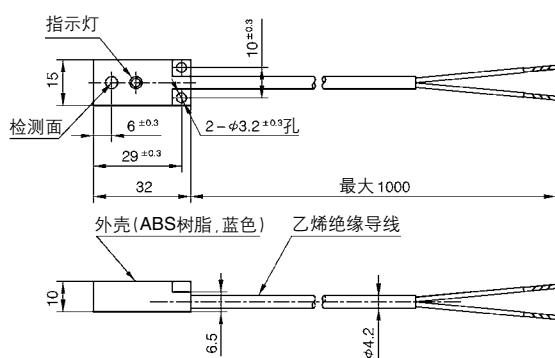
※乙烯绝缘导线(耐热、耐弯曲型: 0.3mm<sup>2</sup>, 60/0.08, 2芯)φ 4.2
