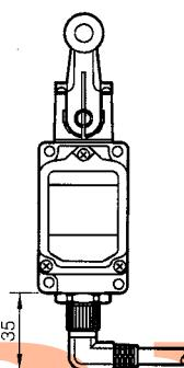
※将弯式连接器PA5组装到连接器型开关上时, PA5的导线引出方向并不是一定的, 请加以注意。
